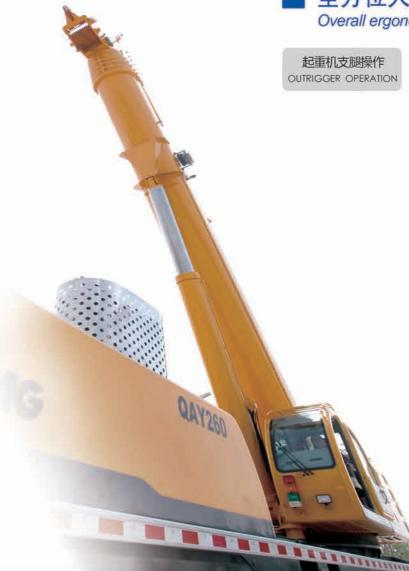
全方位人性化设计 • Overall ergonomic design •不同的支撑位置 支腿完全缩回 半伸位置: 6.5m×8.8m 全伸位置: 8.7m×8.8m • 支脚盘固定安装,由防护罩保护。
