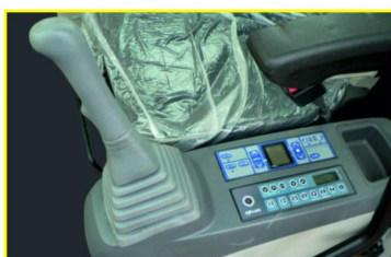
سیستم کنترل ادوات در سمت راست داخل کابین
